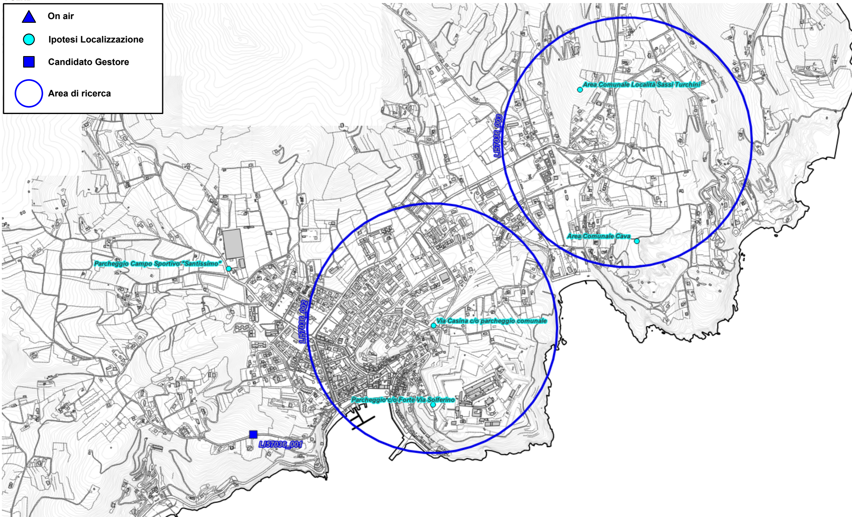
Fig. 10 Dettaglio piano di rete – Gestore ILIAD
