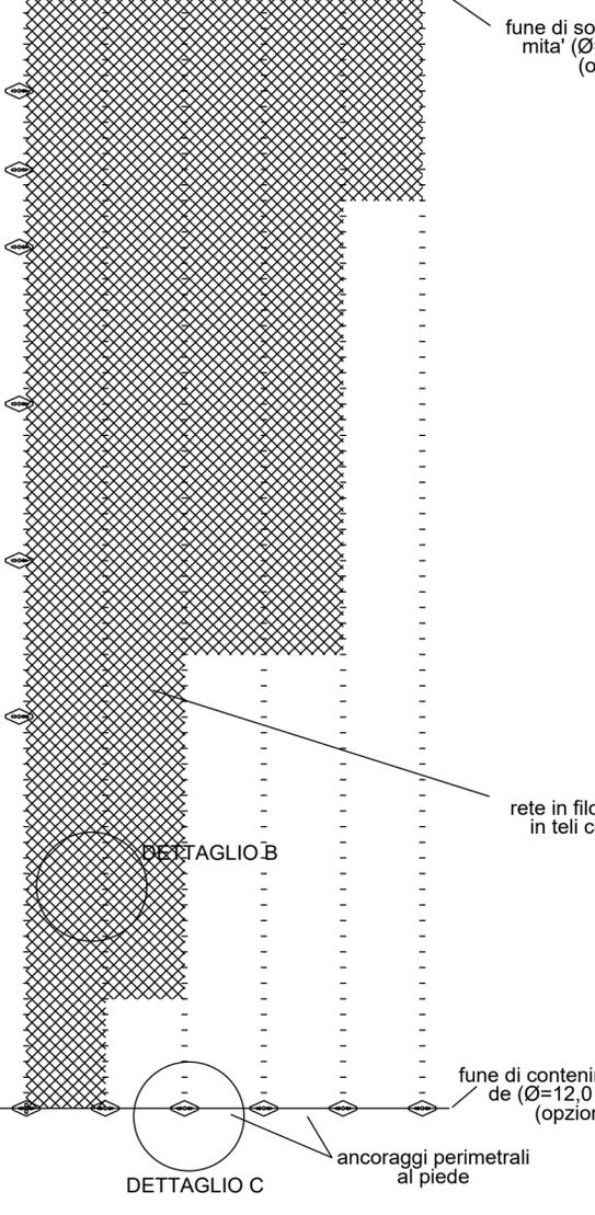
3: realizzazione degli ancoraggi di consolidamento della tipologia indicata in progetto, posa di funi perimetrali e di rinforzo orizzontali e serraggio degli ancoraggi al pre-tensionamento definito
